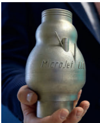
Камера сгорания для энергетической установки, материал ПР-08ХН53БМТЮ (аналог Inconel 718)
