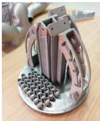
Детали панелей авиационных приборов, материал сталь ПР-03Х17Н12М2 (аналог 316L)
